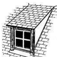
lucarne rampante ou en chien couché
